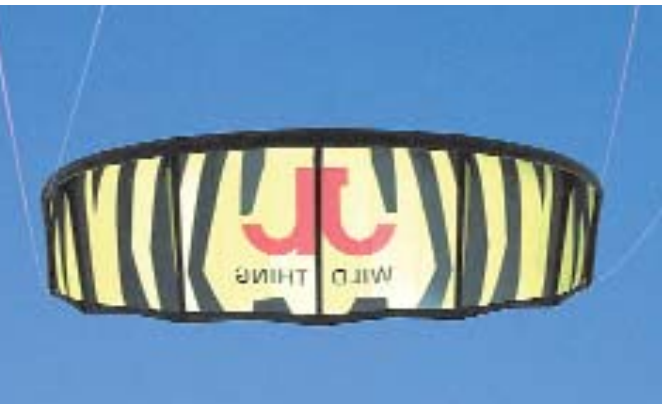
Gemessene Größe ca. 14 m 2 , Spannweite ausgelegt gemessen 8,90 m, größte Tiefe gemessen 1,80m - daraus errechneter AR 4,81
