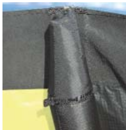
Das Dacron Tuch steht am Strutende über und ist dort umgenäht. Im Tipende ist die Tubehülle umgeschlagen und mit einem Klettverschluss fixiert.
