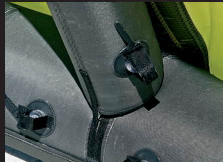
Die Ventile haben einen Entlüftungsdorn, um das Rückschlagventil zu öffnen
